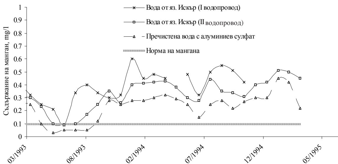
Фиг. 4.2.9. Съдържанието на манган на вход и изход на питейна станция Панчарево от март 1993 г. до май 1995 г. (Източник: Водоснабдяване и канализация на гр. София)
